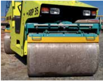
Flexible Arbeitsbreite 1100 – 1924 mm
