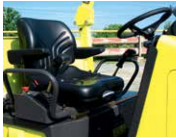
Drehbarer & verschiebbarer Fahrsitz mit 2 Antriebshebeln
