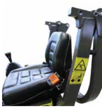
Klappbare ROPS-Bügel für einfachen Transport
