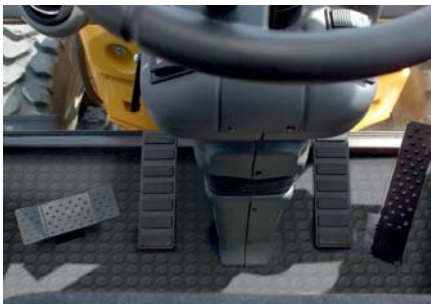
Schwenken mittels Fußpedal für ermüdungsfreies Arbeiten
